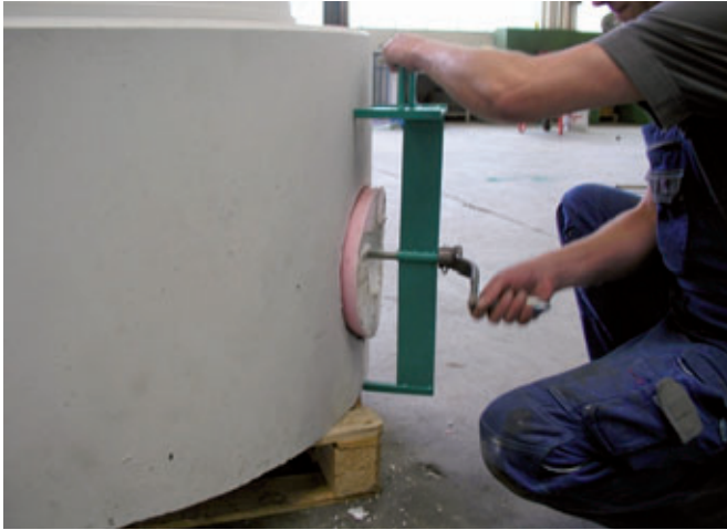
Entfernen der Aussparkerne durch manuelle Ziehvorrichtung
