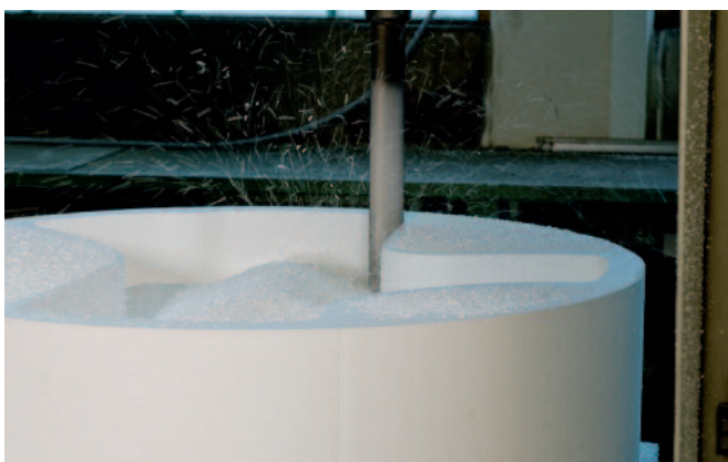
Gerando o modelo de canal utilizando o configurador de produto recém-desenvolvido pela BFS
