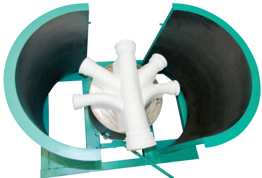
A recém-desenvolvida forma para adensamento de concreto plástico BFS Capitan
