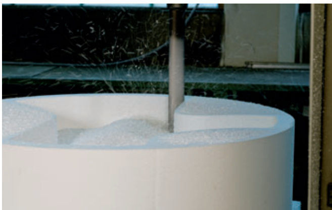
Erstellen eines Gerinnenegatives mit der BFS-Blockfräse
