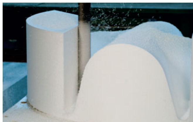
Изготовление модели водовода с помощью разработанной фирмой BFS системы конфигурации продукта.
