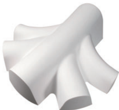
Негативная матрица из пенополистирола
