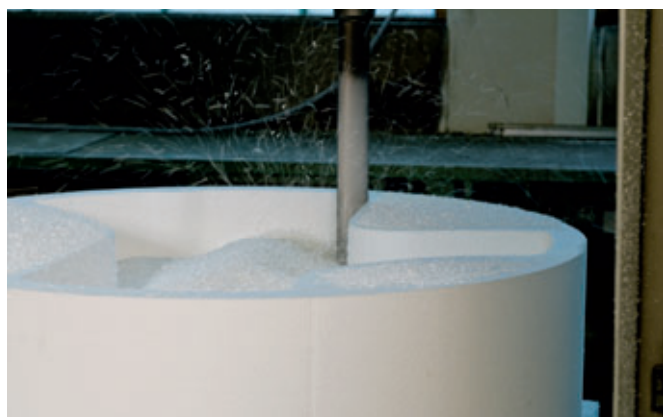
Изготовление модели водовода с помощью разработанной фирмой BFS системы конфигурации продукта.
