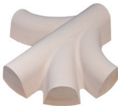
Негативная матрица из связанного парафина или воском песка
